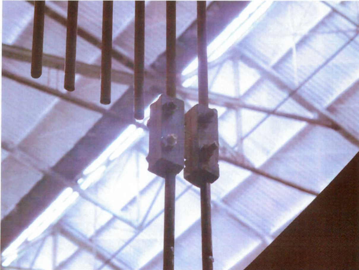
Figura 2.4 Exemplo da conexão entre tubo guia não consumível (acima) e tubo guia consumível (abaixo) (figura gentilmente cedida pela empresa Voith Hydro – São Paulo).
