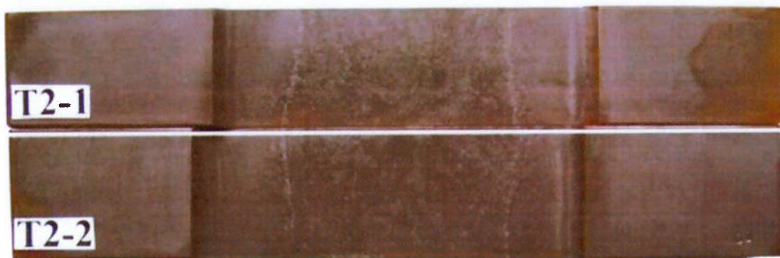
Figura 5.20 Corpo de prova para ensaio de tração (tensão 40 volts).
