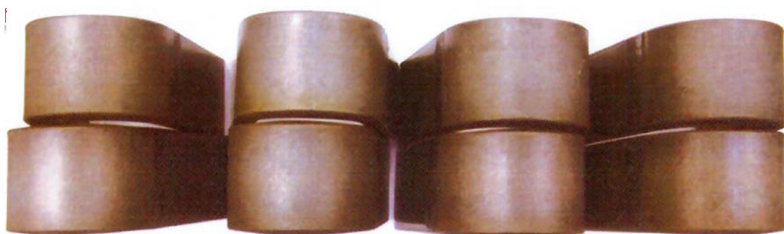
Figura 5.29 Corpos de prova ensaio de dobramento guiado (tensão 40 volts).
