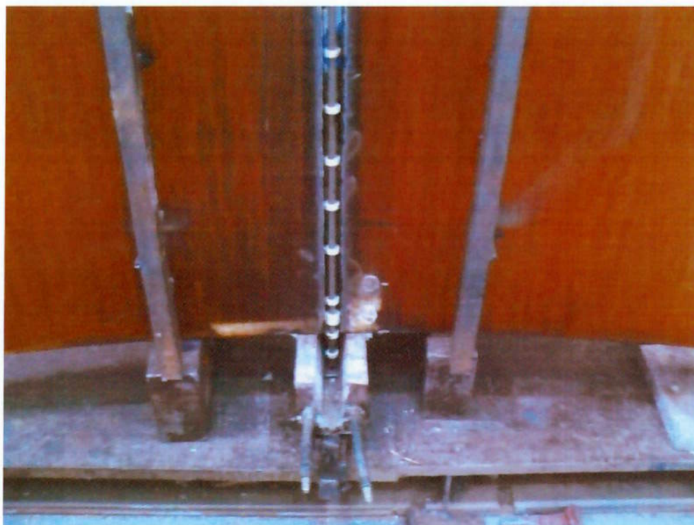
Figura 2.13 Exemplo do posicionamento da sapata de contenção para início da soldagem (figura gentilmente cedida pela empresa Voith Hydro – São Paulo).
