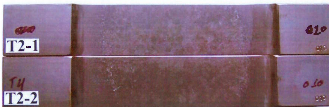
Figura 5.24 Corpo de prova para ensaio de tração (tensão 48 volts).
