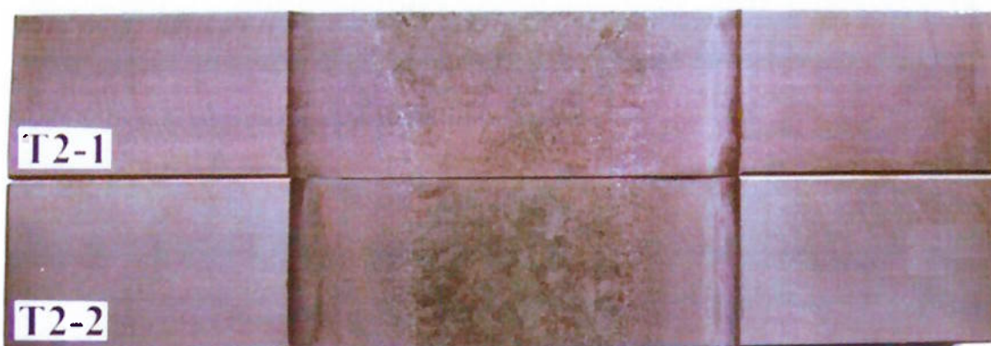
Figura 5.16 Corpo de prova para ensaio de tração (tensão 32 volts).
