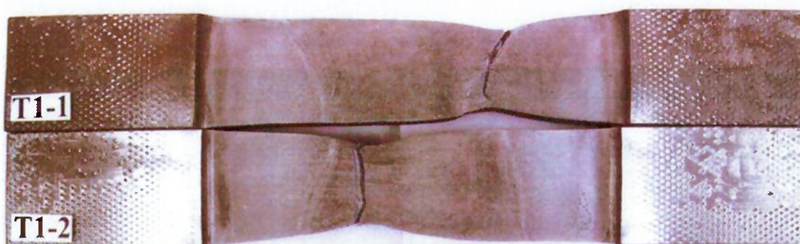
Figura 5.15 Local da fratura corpo de prova (tensão 32 volts).
