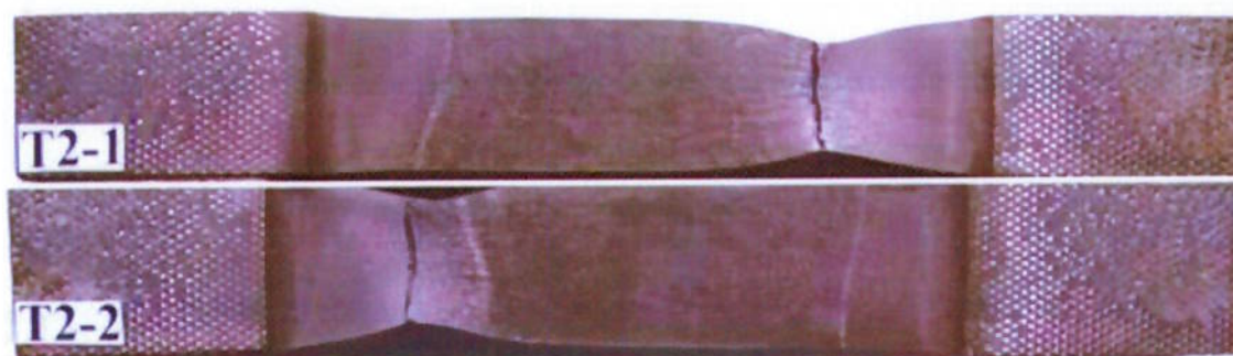
Figura 5.21 Local da fratura corpo de prova (tensão 40 volts).
