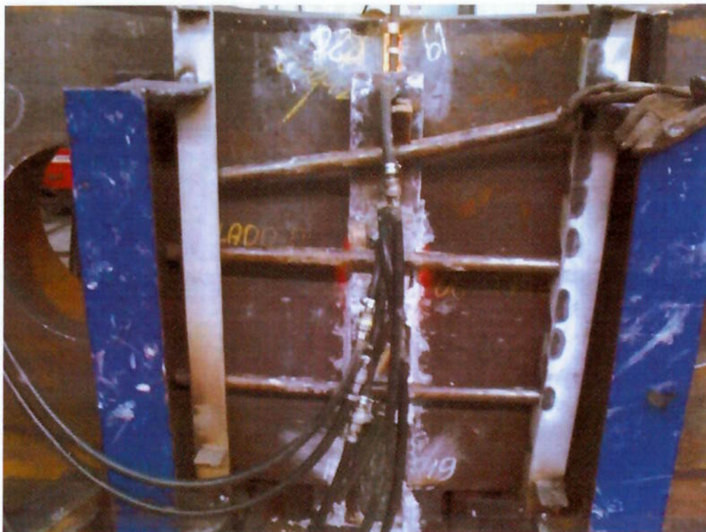
Figura 2.15 Exemplo de sapatas de contenção lateral conectadas a refrigeração posicionadas por travas e cunhas (figura gentilmente cedida pela empresa Voith Hydro – São Paulo).
