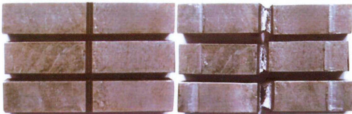
Figura 5.38 Corpo de prova impacto (tensão 32 volts).
