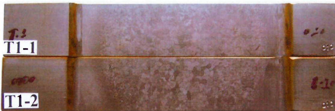
Figura 5.22 Corpo de prova para ensaio de tração (tensão 48 volts).
