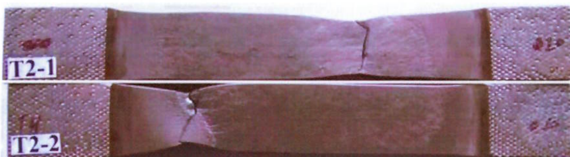
Figura 5.25 Local da fratura corpo de prova (tensão 48 volts).
