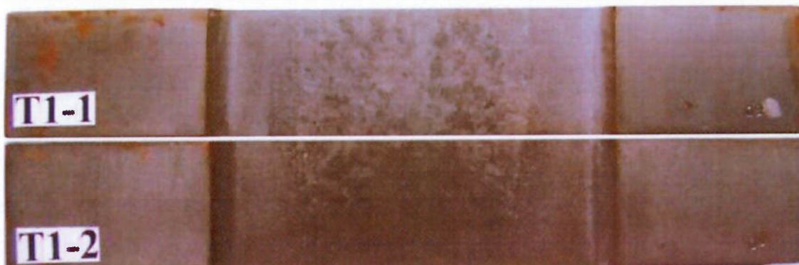
Figura 5.18 Corpo de prova para ensaio de tração (tensão 40 volts).
