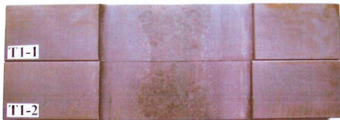
Figura 5.14 Corpo de prova para ensaio de tração (tensão 32 volts).
