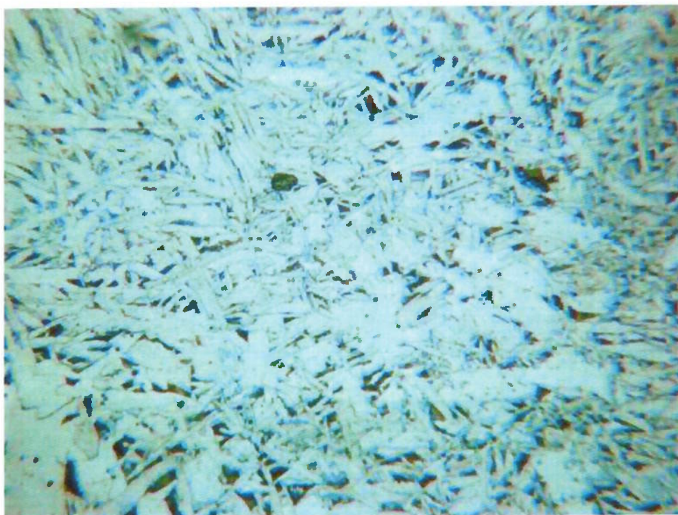
Figura 5.41 Corpo de prova (tensão 32 Volts) ataque Nital 3% aumento 100 vezes.
