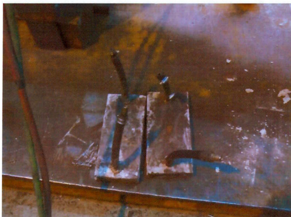
Figura 2.14 Exemplo de sapatas de contenção lateral utilizadas durante a progressão da soldagem (figura gentilmente cedida pela empresa Voith Hydro – São Paulo).
