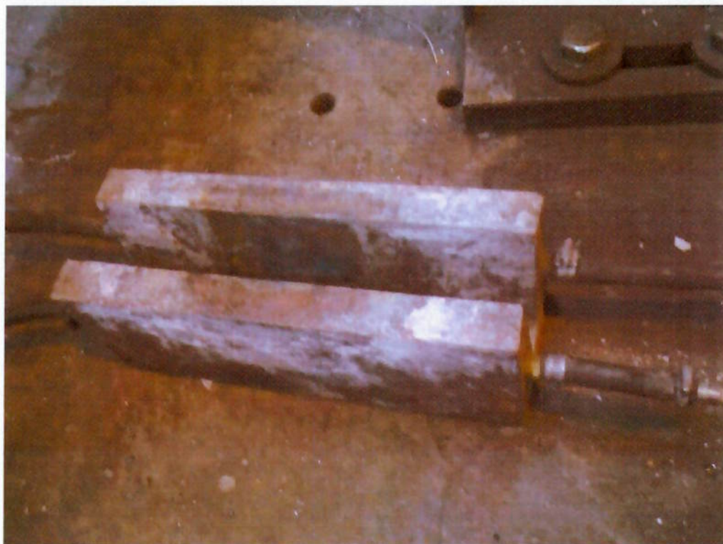
Figura 2.11 Exemplo de sapata de contenção utilizada para início da soldagem (figura gentilmente cedida pela empresa Voith Hydro – São Paulo).
